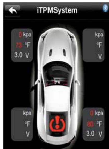
Aktivni oziroma direktni TPMS deluje s pomočjo lastnih senzorjev, ki so sestavni del ventila na notranji strani platišča – meri lahko tudi temperaturo zraka v pnevmatiki.
