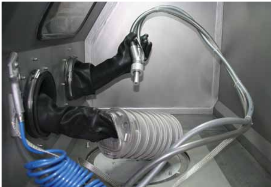
Notranjost specialne kabine za peskanje sintranih titanovih izdelkov s curkom abraziva, vrednega več kot 200 dolarjev za kilogram. Postopek teče v kontrolirani atmosferi, polucije v prostor in okolici so enake nič.
