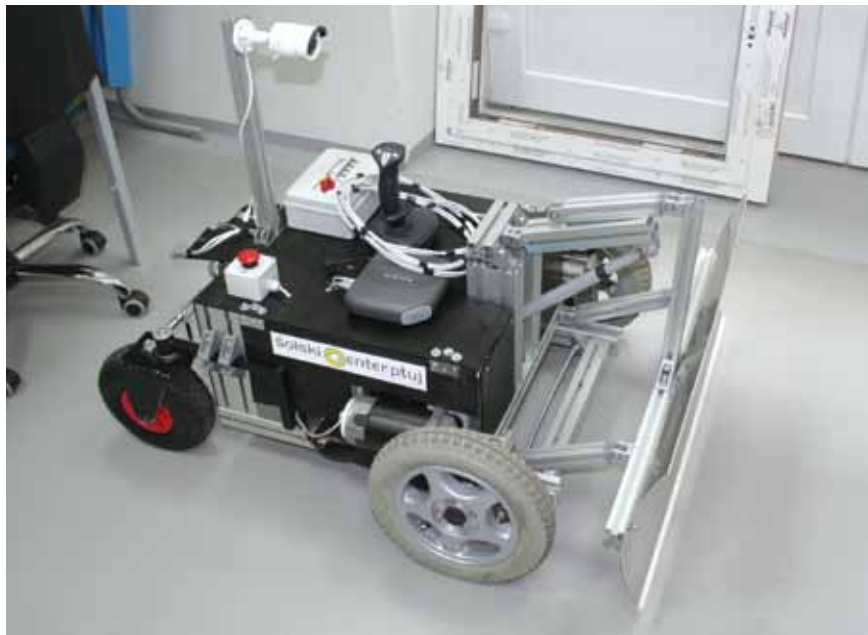
Robotski daljinsko vodeni snežnim plug, ki ga je šolska ekipa izdelala v HNT, z nim so na zadnjem evropskem tekmovanju RoboCup na Portugalskem aprila letos dosegli izvrstno drugo mesto.
