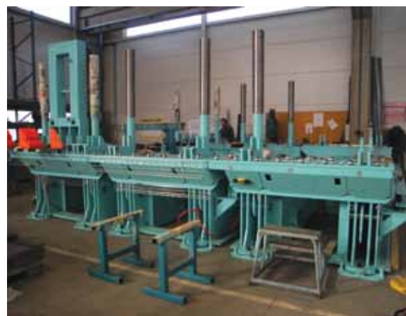
X-press, eden najbolj udarnih in najbolj prodajanih strojev podjetja Ledinek, stiskalnica za križno lepljenje panelnih plošč.
