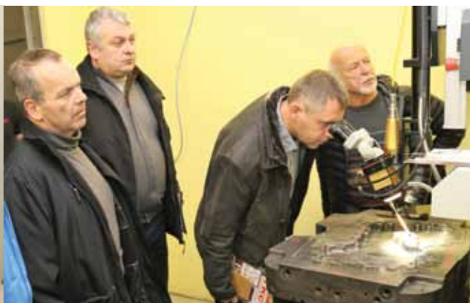
Z laserskim varjenjem lahko v IKC zelo učinkovito obnavljajo poškodovana orodja.
