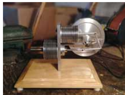
Del poklicne mature je tudi izdelek s seminarsko nalogo. Nejc Koželj je izdelal Stirlingov motor, mehansko napravo, ki pretvarja toplotno energijo v mehansko delo.
