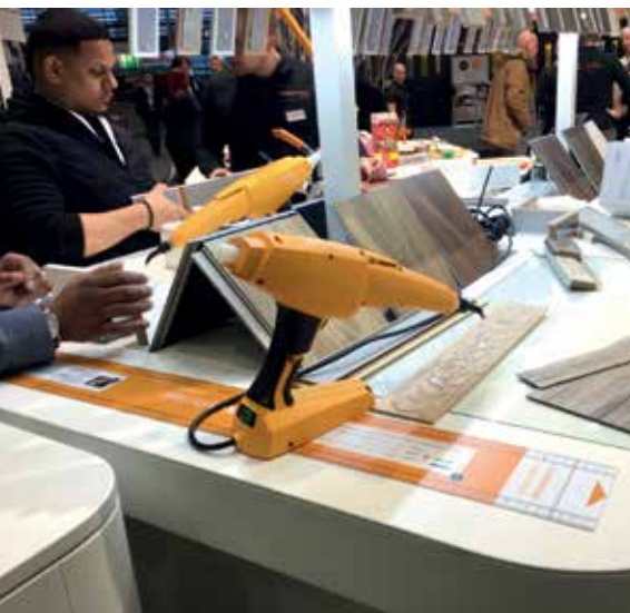
Prva elektronsko krmiljena pištola za vroče lepilo, zasnovana posebej za pritrditev plošč – Döllken Profiles GmbH. (foto: M.R.)
