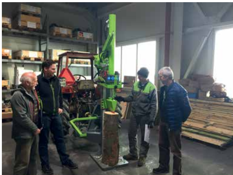
Vrhunski zaključni izdelek vajenca. Vajenec je hidravlični cepilec drv izdelal od začetka do konca praktično sam.
